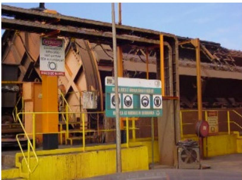
Figura 14 – Virador de Vagões em Descarga
