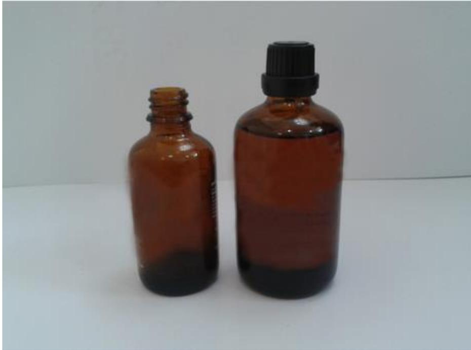
Foto 09- Modelo de frasco de borosilicato com capacidade de 100ml e tampa rosqueável, para amostragem de óleo (análise de BETEX).
