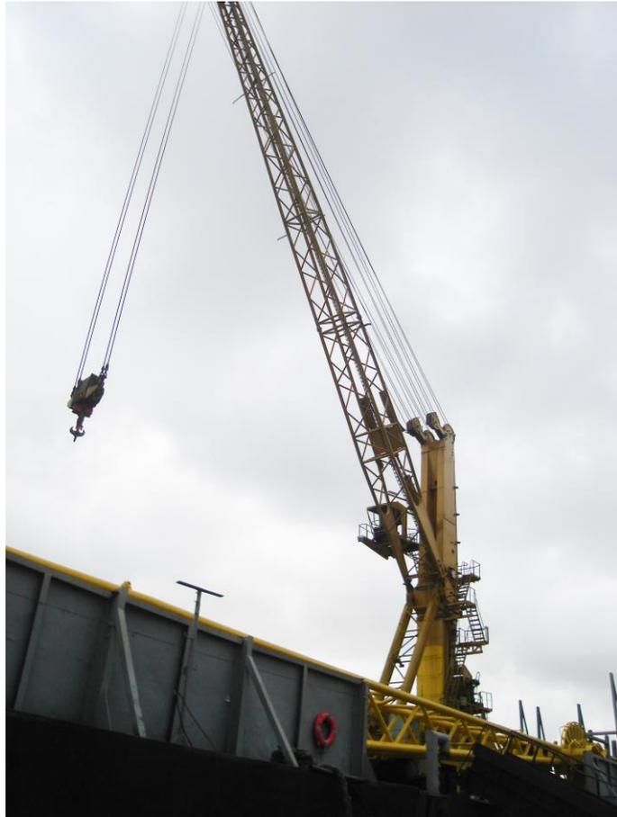
Foto 07 – Guindaste sobre embarcação não-propulsada.
