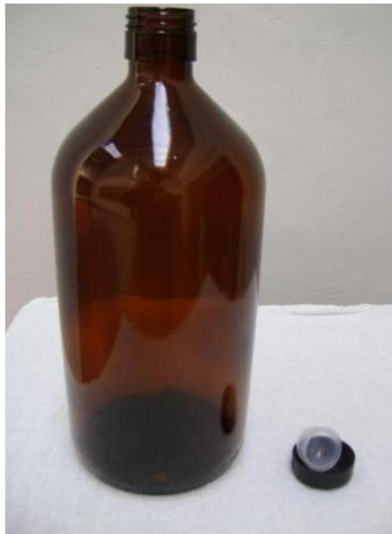
Foto 10 - Modelo de frasco de borosilicato, cor âmbar, com capacidade de 1L para amostragem de óleo (análise de PAH/Benzeno)
