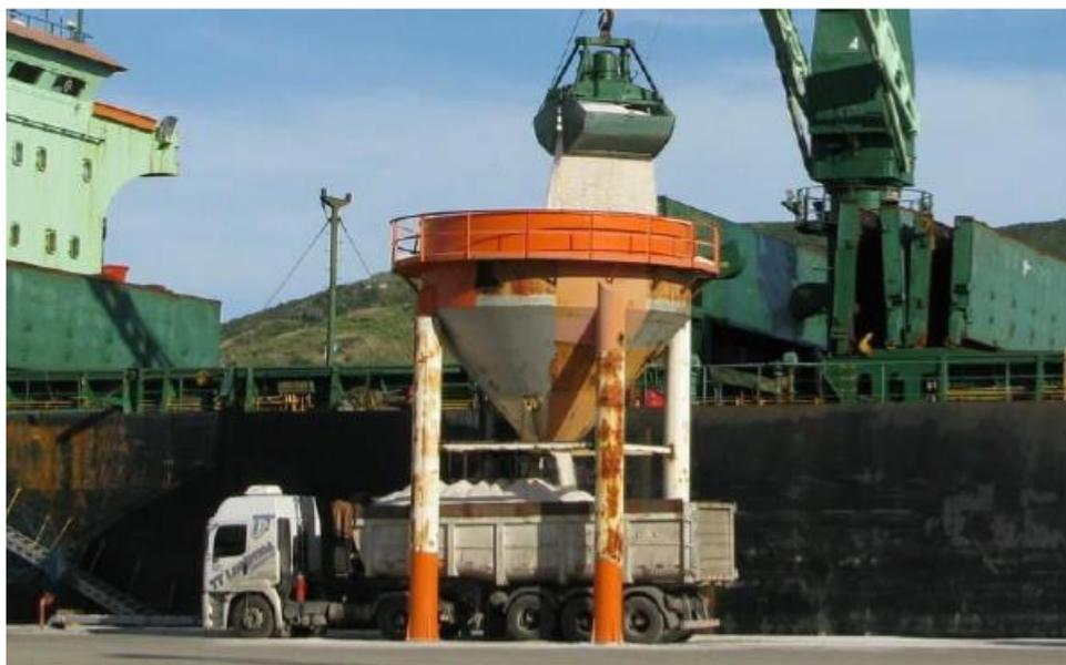
**Figura 39 - Descarga Direta de Sal – Porto do Forno**
