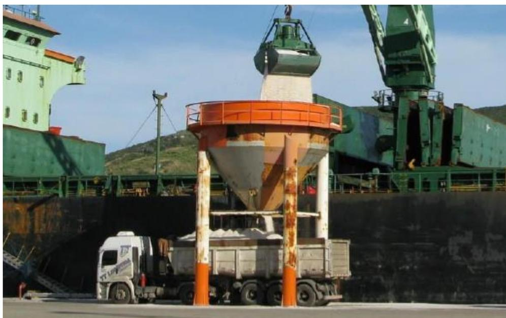
Figura 46 – Descarga Direta de Sal – Porto do Forno
