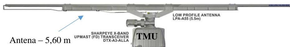
Foto 4: - Antena com a Unidade de Giro (TMU) – DTX-A3 - radar SBS 800-3
